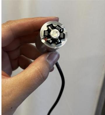
Luego, debes introducir todo este componente en el tubo, para luego afirmarlo con un anillo. Para ello, debes posicionar el anillo en los toques de la herramienta que construiste en la segunda etapa, introducirlo en el tubo y atornillar apretando (en sentido horario) hasta que la herramienta marque 33 mm de profundidad.
