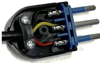
Para fijar los cables, debes soltar el tornillo respectivo e introducir las fibras del cable dentro del orificio y luego atornillas nuevamente hasta que quede apretado. Una vez finalizado, ensambla el enchufe nuevamente.
