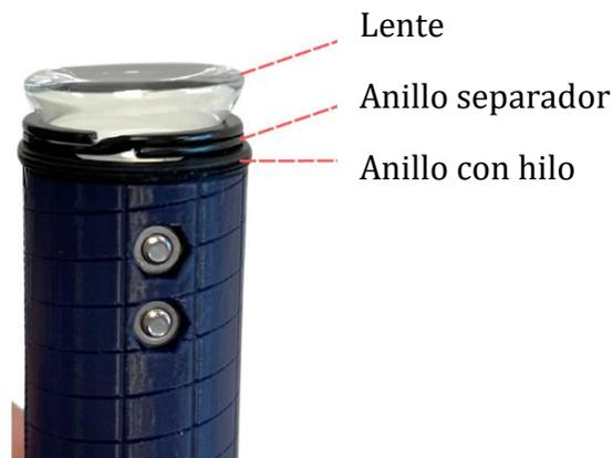
Luego manteniendo la herramienta en su posición vertical con el lente encima, se debe enroscar el tubo por encima de ella, hasta llegar a una profundidad de 16 mm.
